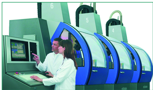
Abb. 2: Fräszentren sind auf standardisierte Fertigungsverfahren unter besonders wirtschaftlichen Gesichtspunkten eingestellt. Foto: Straumann
