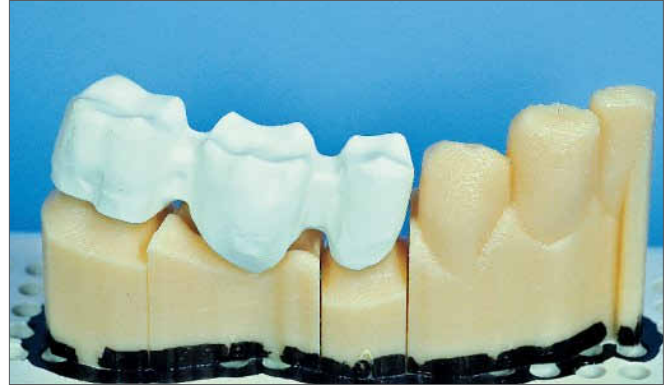
Abb. 13: ZrO 2 -Gerüst bei der Aufpassung [Foto: Baltzer]
