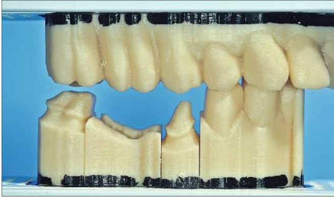
Abb. 12: SLA-Modell (Acryl) für die Aufpassung des Gerüsts [Foto: Baltzer]
