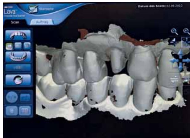
Abbildung 8 Optoelektronischer Intraoral-Scan, System C.O.S. Lava. Kronenstumpf und Präp-Grenze sind exakt dargestellt. Der Datensatz erlaubt neben der Gerüstfertigung auch die Produktion eines Kunststoffmodells mit Gegenbiss. (Abb. 8: Wöstmann)
