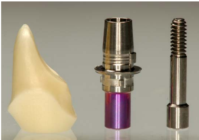
Abb. 4: Die Titanhülse stabilisiert das ZrO_2 -Abutment und vermeidet Zugspannung bei Verschraubung. Quelle: Beuer/Schweiger
