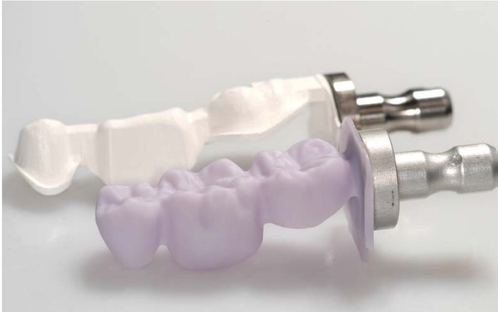
Abb. 8: Ausgefrästes Brückengerüst aus ZrO_2 (hinten) und Verblendschale aus LS_2 vor dem farbbestimmenden Kristallisationsbrand. Quelle: Beuer/Schweiger
