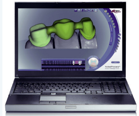
Automatischer Gerüstvorschlag mit Erkennung der Präparationsgrenze, korrekte Ausformung der Brückenstruktur. „Cut-Back-Funktion“ für die Verblendkeramiksicht.
