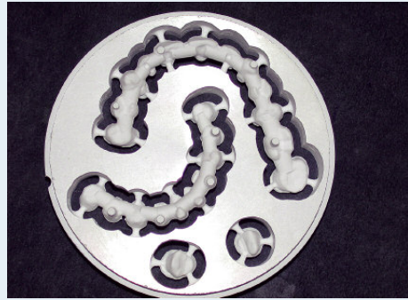
ZrO 2 -Disk als Grünling mit ausgefrästen Kronen- und Brückengerüsten. Der Hersteller-Barcode erschließt die Schleifstrategie, Sinterschrumpfung, Passgenauigkeit und den Festigkeitswert.
